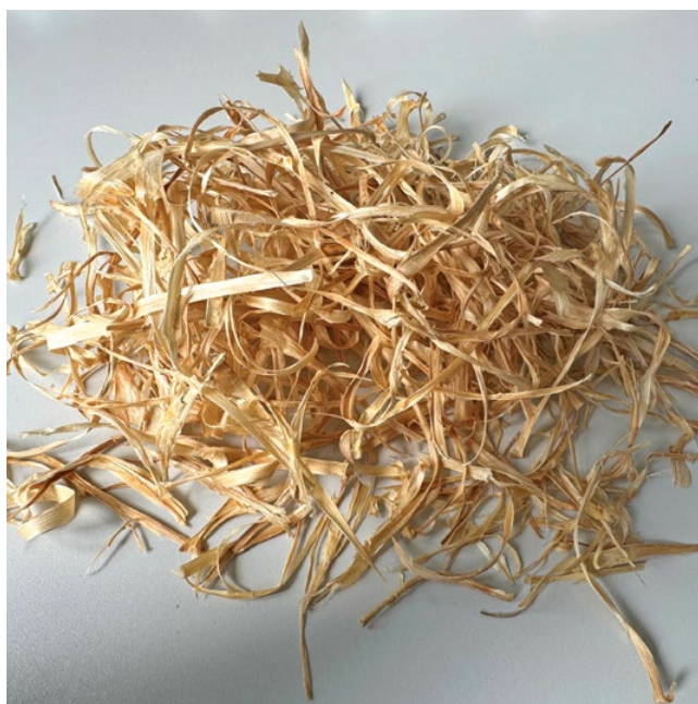
Auch Reststoffe wie beispielsweise getrocknete Spargelschalen können für Biokunststoffe und Bioverbundwerkstoffe genutzt werden.
